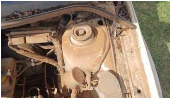
Foto Estrutura Torre do Amortecedor Esquerdo
