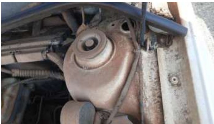
Foto Estrutura Torre do Amortecedor Esquerdo
