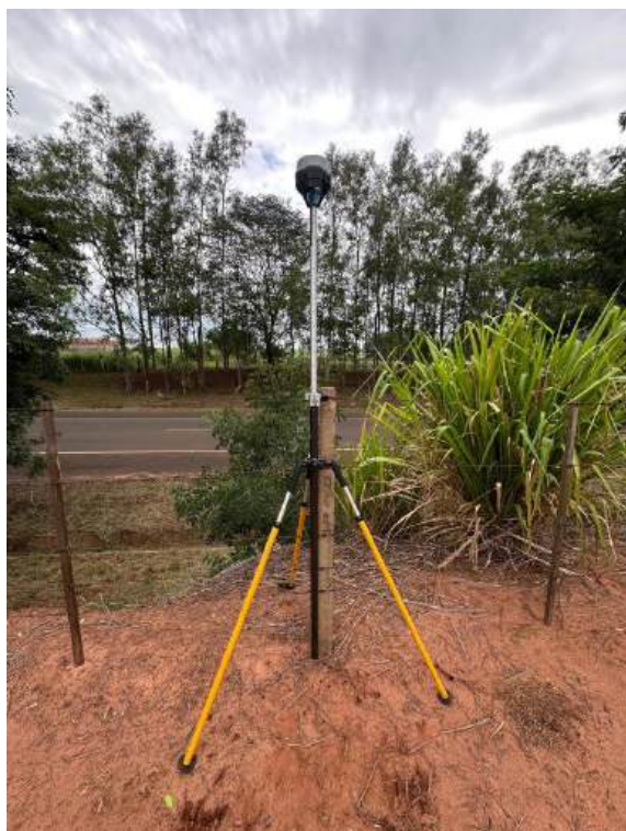
Foto 01 – Base Georreferenciada para o levantamento planimétrico da propriedade.
